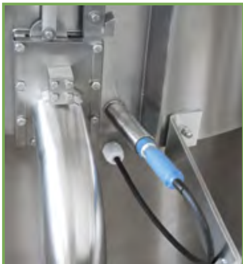
Zabudované čidlo pro měření hodnoty pH pro automatické měření a stanovení kyselosti kvasu a omládku
