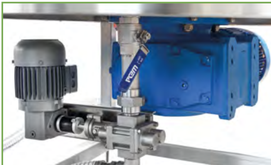
Nouzová výpust' pod výrobníkem k jednoduchému vyprázdnění kvasu nebo odpadní vody
