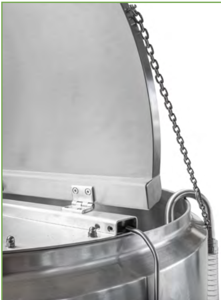
Nové vymezovací řetízky k potřebnému zajištění jak dalece má být otevřeno víko výrobníku při plnění výrobníku surovinami
